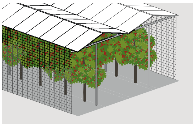
First über Pfosten, Ost-West-Ausrichtung
